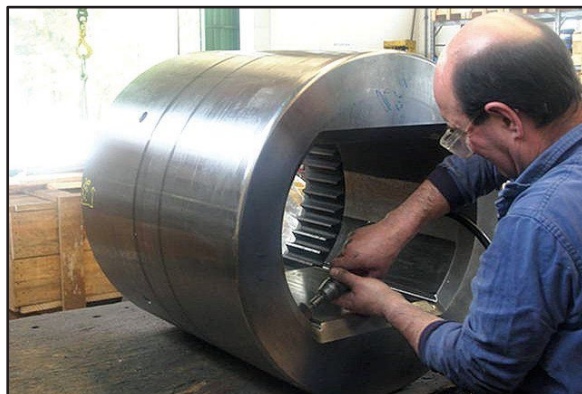
Rebarbação da caixa de acoplamento
