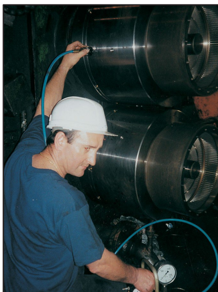
Bombeamento de óleo em um fuso com Safeset®
