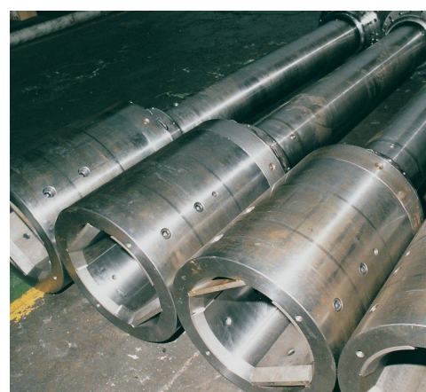
Fusos de engrenagens AL. (Torque nominal até 6500 kNm)
